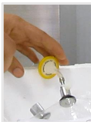
Figura 22 - Conexão da válvula de entrada do saco ao tubo de sucção do aparelho INNOVA 1412
