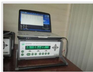
Figura 21- Equipamento de medição de gases: INNOVA 1412 e Computador - O processamento consiste na deteção fotoacústica infravermelha dos gases a quantificar, com recurso a filtros óticos, que procedem ainda à compensação das interferências provocadas pelo vapor de água e outros gases de interesse desprezável (AMORIM, 2012)
